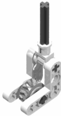
**Illustration 2-17. Roulette construite à l'aide d'une roue conique de 12 dents**
